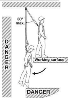
**AVERTISSEMENT: Il faut jamais rattacher un absorbeur d'énergie de retour sur lui-même. Les connecteurs sur les absorbeurs d'énergie ne sont pas conçus pour être utilisés de cette façon et cela pourrait entraîner des blessures graves ou la mort.**
