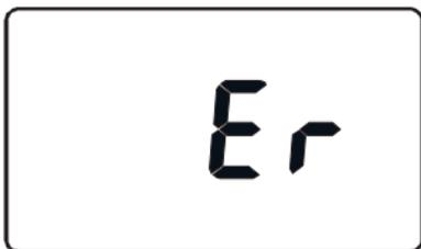
**Remarque:** Cette erreur peut être causée par le fait que la mâchoire de la pince n'est pas correctement fermée ou que de la saleté s'est accumulée sur la surface métallique de la mâchoire de la pince.
