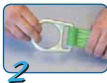
**2) Anneaux en D / coussinets dorsaux** – Examinez les anneaux en D pour détecter toutes distorsions, fissures, cassures ou bords inégaux ou acérés. L'anneau en D doit pouvoir pivoter librement. Les coussinets d'anneaux dorsaux en D doivent également être inspectés.
