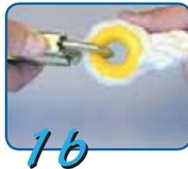
b. Œillets : L'œillet de garnissage doit être fermement emboîté dans la boucle de l'épissure, et l'épissure ne doit comporter aucun brin sectionné ou détaché. Les bords de l'œillet de garnissage ne doivent pas être tranchants et doivent être exempts de distorsion et fissures.
