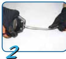
2) Longe d'acier – Lors de la rotation du câble d'acier, recherchez les coupures, brins déformés ou rompus, ou zones d'usure inhabituelle du câble. Les brins rompus peuvent se séparer du corps du câble.
