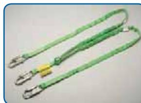
Si une jambe d'une double cuissarde ( avec sac amortisseur OU amortisseur de style tubulaire ) n'est pas utilisée, elle ne doit pas être fixée à un composant permanent du harnais, comme les anneaux latéraux en D. L'amortisseur ne pourrait plus fonctionner adéquatement.
