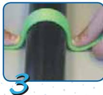
3) Longe de sangle – En cintrant une sangle sur un tuyau ou autre accessoire cylindrique, observez chaque face de la sangle. Vous serez en mesure de détecter les coupures et les ruptures. Les gonflements, changements de couleur, fissures et traces de combustion sont des indices évidents de détérioration par la chaleur ou les produits chimiques. Recherchez attentivement les brins rompus.
