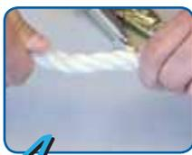
**4) Longe de cordage** – Par la rotation de la corde lors de son inspection d'une extrémité à l'autre, il sera possible de détecter les brins coupés, rompus, usés ou détériorés. Toute zone affaiblie par une charge extrême sera caractérisée par une modification notable du diamètre initial. Le diamètre de la corde doit être uniforme dans toute sa longueur après une brève période de rodage.
