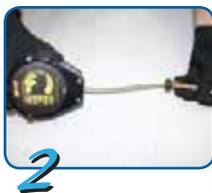
**2) Filin** – Vérifiez la rétraction et la tension du filin en déroulant plusieurs pieds du filin et en lui permettant de réintégrer le boîtier. Maintenez toujours une faible tension sur le filin lorsqu'il se rétracte. Le filin doit être tiré librement et s'enrouler complètement dans l'unité. Ne pas utiliser l'unité si le filin ne se rétracte pas.
