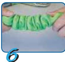
**6) Longe amortisseur** – Examinez les longes amortisseurs comme une sangle ( description à l'article 3 ci-dessus ). De plus, voir si le drapeau de mise en garde a été activé, ou recherchez des signes de déploiement. Si le drapeau a été activé, la longe amortisseur doit être mise hors d'usage.
