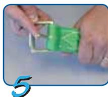
**5) Ardillons de boucles** – Les ardillons de boucles ne doivent présenter aucune distorsion ni défaut de mouvement. Ils doivent chevaucher le cadre de la boucle et bouger aisément en va-et-vient sur leur point d'articulation. Le rouleau doit tourner librement sur le cadre. Assurez-vous qu'il n'y ait ni distorsion, ni bords acérés.
